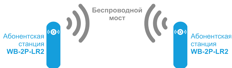
Функциональная схема использования WB-2P-LR2 для организации беспроводного моста
