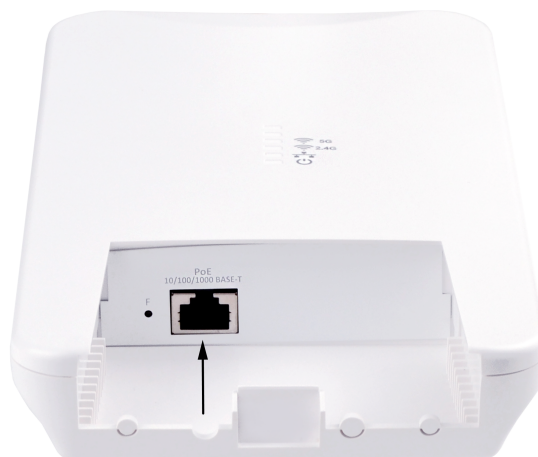
Рисунок 15 — Подключение Ethernet-кабеля к PoE-порту
